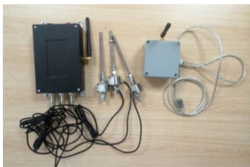
图 1 拉压传感器、电源、红外线发射器
